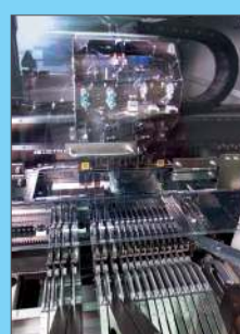
Manipulator Automat SMD pro výběr a osazování SMD автоматический манипулятор для захвата и установки деталей
