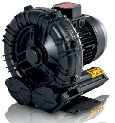
Принцип дії вихрових канальних повітродувок FPZ (Італія) базується на теорії регенеративної (зворотної) течії повітря: радіальні лопатки робочого колеса направляють потік повітря (газу) назовні. Додатково, на потік впливає відцентрова сила, тим самим, ще більше ущільнюючи потік. Далі, стиснене повітря надходить у бічний канал і входить у наступну камеру, прямуючи до основи лопаток. Процес повторюється багато разів, таким чином, стискаючи повітря у декілька прийомів.
