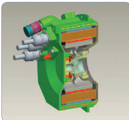
Электрический стартер/генератор мощностью 200 кВт
