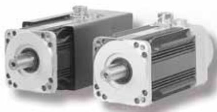
Serie di servomotori **sincroni** («**brushless**») con rotore a magneti permanenti a elevata densità di energia e **asincroni** («**vettoriali**»), servoventilati con rotore a gabbia di alluminio pressofuso
