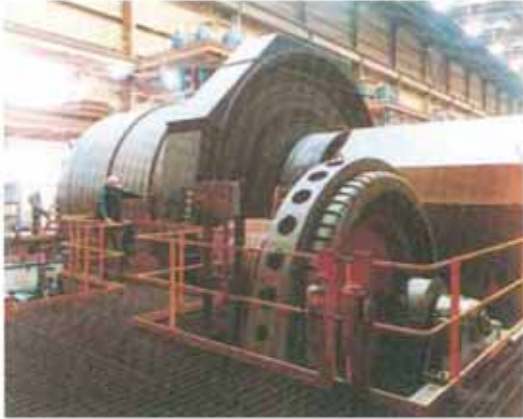
Муфта SV360 сферической фрезы Allis Chalmers
