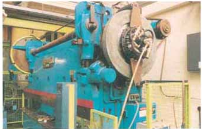
Переоборудование прессового тормоза серии 5 Cincinnati с комбинированным агрегатом муфта сцепления/тормоз CCB 380 REP
