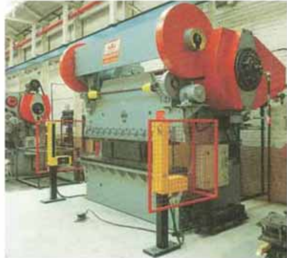
Прессовый тормоз Kingdom — Taylor PCAB – комбинированный блок муфта/тормоз
