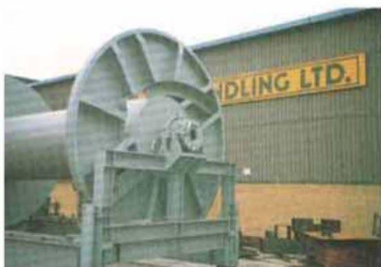
Барабан канатной перегрузочной установки Wise Handling – муфта SV218 + тормоз LIM 218
