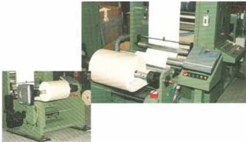
4-цветная машина для флексографической печати Flexotecnica – регулятор натяжения – Micro Web – дисковый тормоз Magnum 400/4
