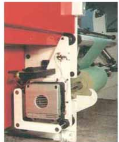
Продольно-режущий станок Даффи Магнум 260/2 – тормоз натяжного устройства
