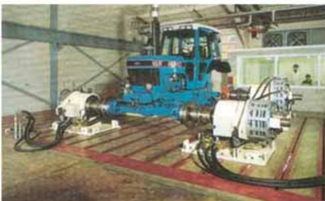
Модернизированный осевой инерционный стенд для испытания тормозов и муфт Plint & Partners в исследовательском институте Silsoe Bedford – тормоза CSM 224 на передних колесах, тормоза CSM 130 на задних колесах.
