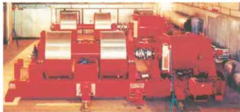
Муфты приводов главной силовой установки и генератора на судне Royal Princess – муфты MLI 248 и SV 430
